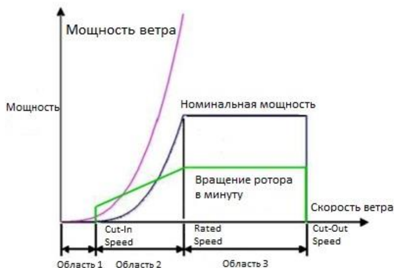
Рисунок 1.1 - График зависимости мощности ветрогенератора от скорости ветра
